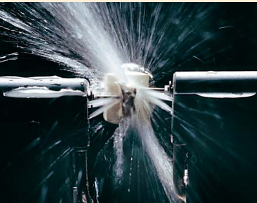
Die CAD/CAM-Technik ermöglicht das vollautomatische Ausschleifen der Restauration in 10 – 20 Minuten.
